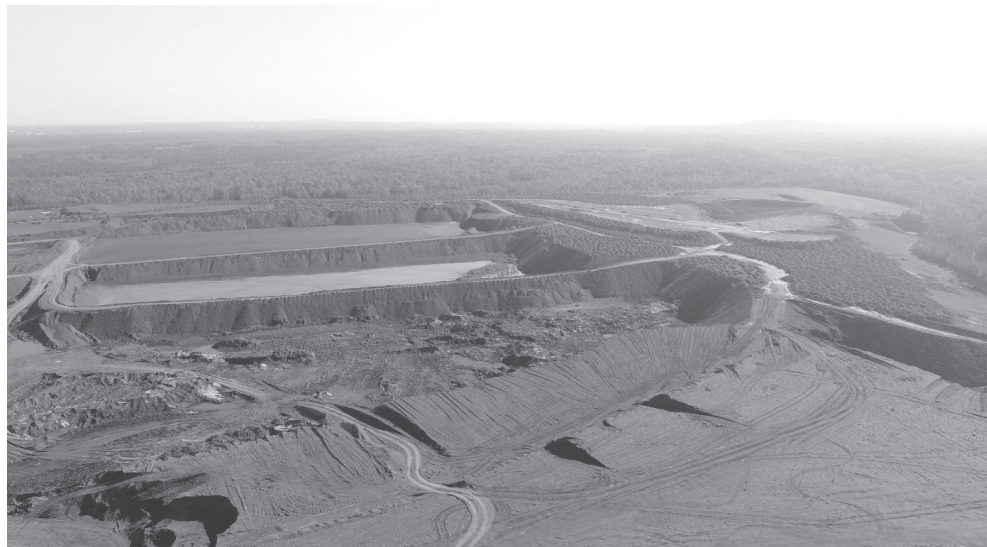
Fotografia 4. Eksploatacja zwałowiska Panewniki – widoczne: zbiornik wody technologicznej i drogi technologiczne
